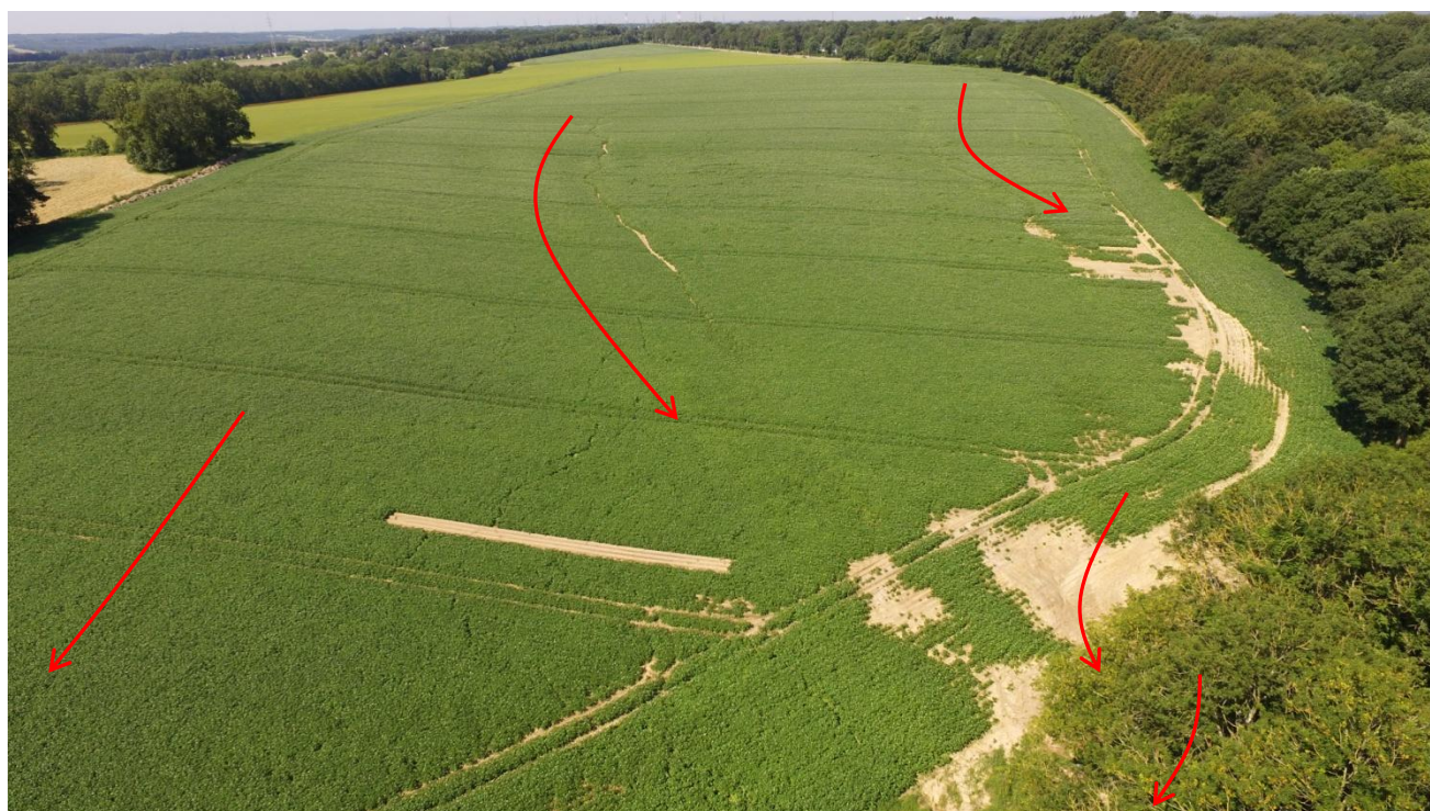
Photo 3 : Vue aérienne de l'amont du bassin 1, montrant les dépôts de terre dans la culture de pomme de terre (photo prise le 28/6, soit un mois après les orages).
